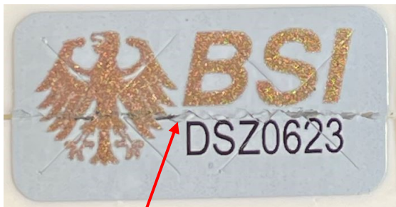
Abb. 3 (Siegel beschädigt im Bereich der Gehäuseschalen)
