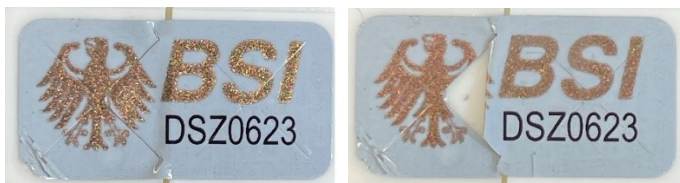
Abb. 4 (Siegel beschädigt, siehe eingerissene Kanten/Flächen)
