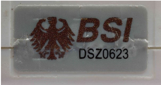
Abb. 4 (Siegel beschädigt, siehe eingerissene Kanten)
