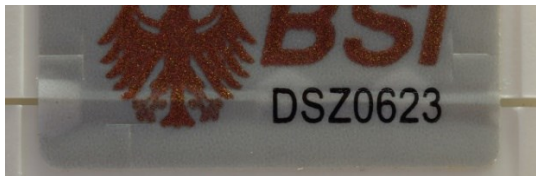
Abb. 3 (Siegel beschädigt, siehe helles Wabenmuster)
