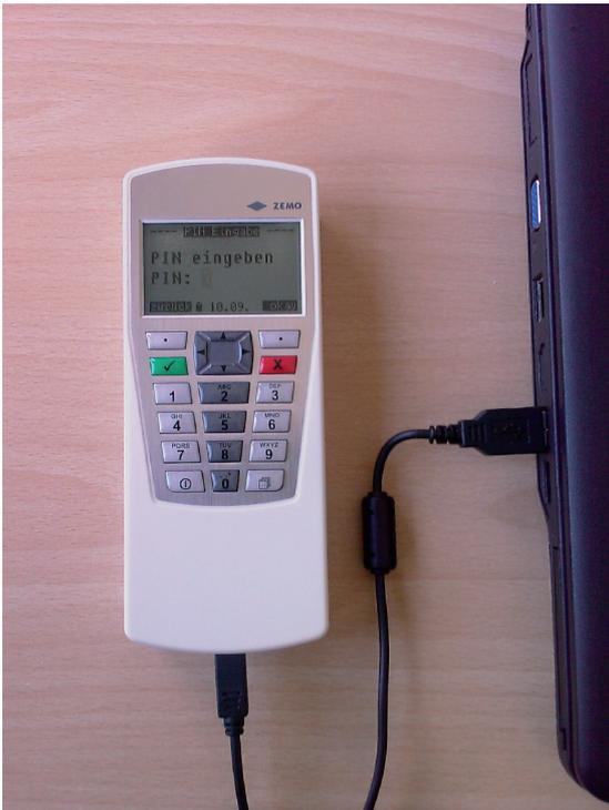
Das Gerät schaltet sich ein, sobald es am PC angeschlossen wird. Es wird nun über USB mit Strom versorgt
