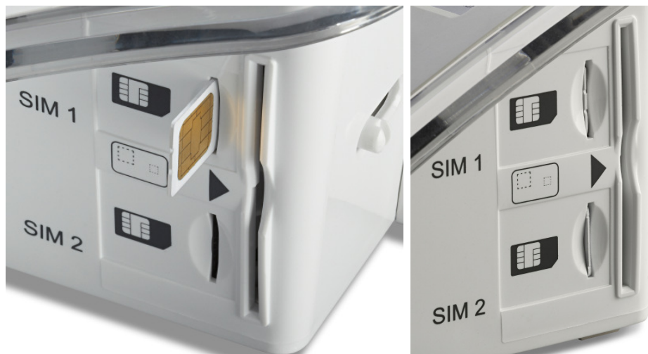
Abbildung 12: SMC Karten Steckrichtung (links) und voll eingesetzt (rechts)
