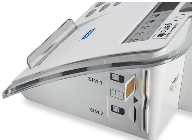
Abbildung 4: Position der SIM-Karten Steckplätze
