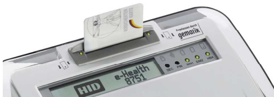
Abbildung 10: Steckrichtung eGK / KVK Karte
